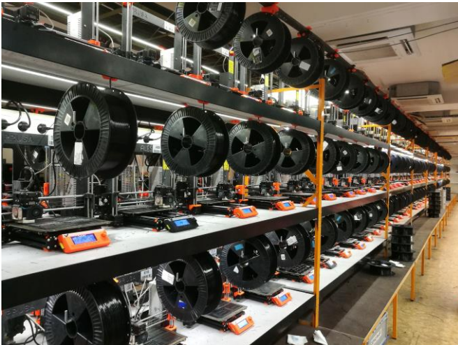
Die Druckerfarm von Prusa – hier werden rund um die Uhr auf mehr als 500 3D-Druckern Teile für 3D-Drucker gedruckt.
